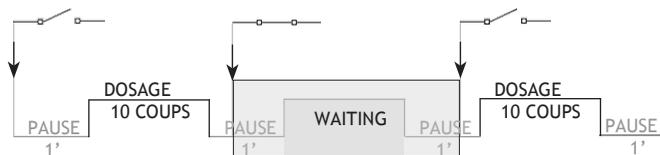
Fig. 24. Batch -mode interne- mode de fonctionnement de la pompe avec un cycle pause-travail réglé par un contact externe. Cas 2.
