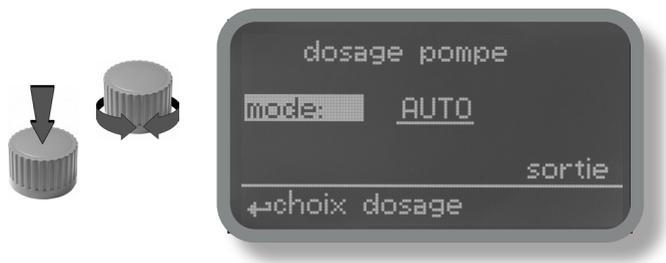
Amener le curseur sur "Mode" et appuyer pour sélectionner. Choisir "Man. Pump1" pour la pompe pH ou "Man. Pump2" pour la pompe du Redox.
