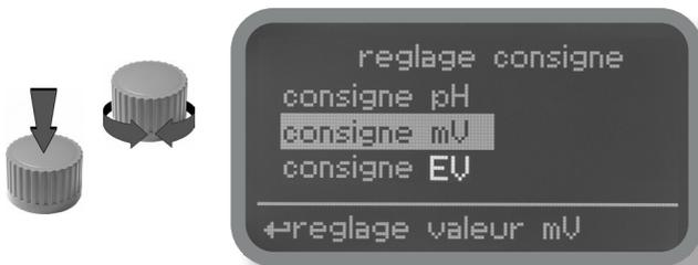
**Le mode Proportionnel prévoit la configuration dans l'appareil du pourcentage de fonctionnement calculé entre deux valeurs qui activent ou désactivent la sortie EV.**
