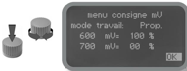
**MODE PROPORTIONNEL compris entre 700mV(0 %) et 600mV (100 %). [Stroke setting 180 coups]**
