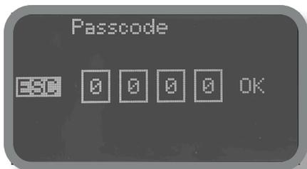
Pour configurer un nouveau mot de passe, sélectionner "Parametres" dans "Menu Principal", mettre en évidence "Nouv code", enclencher le bouton et saisir 4 chiffres. Sélectionner "Sortie" (quitter) et répondre "OUI" pour enregistrer. Le nouveau mot de passe est maintenant habilité.
