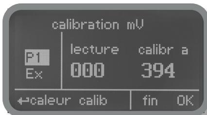
**Attention : cette procédure suppose que l'appareil soit correctement configuré, qu'il soit raccordé à une sonde Redox en parfait état et qu'il soit installé dans le système. La mesure doit être effectuée en utilisant l'eau du circuit. Dans le cas contraire, les résultats pourraient ne pas être fiables.**
