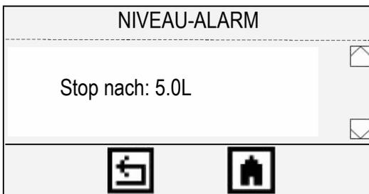
Der Niveau Alarm ist ein Voralarm für das Behälterniveau. Wenn der Behälter nachgefüllt wird, erlischt die Alarmmeldung. In diesem Menü kann die Restmenge eingestellt werden die nachdem der Niveauschalter ausgelöst hat noch im Behälter zurückbleibt und von der Pumpe noch gefördert werden darf.
