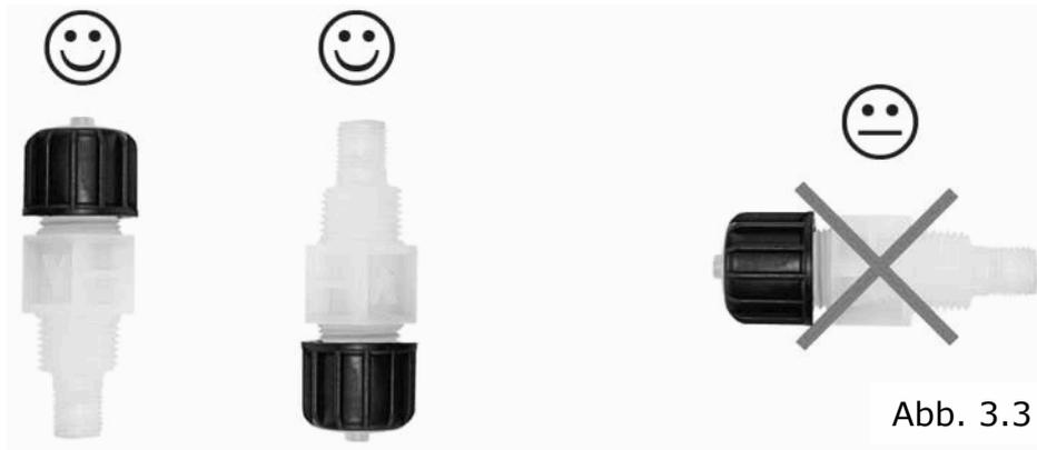
Installieren Sie das Impfventil - wenn möglich - bevorzugt in senkrechter Lage von oben oder unten in die Systemleitung. Bei einer waagerechten Montage besteht u.U. die Gefahr - besonders bei geringen Systemdrücken - dass das Ventil nicht vollständig dicht schließt.
