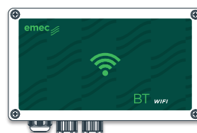
BT WIFI Dispositivo per connessione WIFI. IP65
