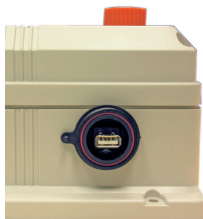
Insira a pen drive no conector USB (lado direito do instrumento) Após a utilização, feche a pen drive com a tampa.
