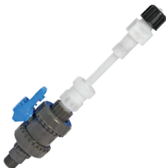
LINIR Injektionslanze 1/2" für die Dosierung von Natriumhypochlorit bei har- tem Wasser. Selbstreinigende Einspritzdüse. O-Ring aus Viton®. Gehäuse aus PVC.
