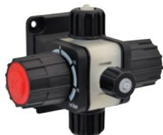
Vanne multifonction pour : pression, sécurité, casse-siphon, purge. Champ de réglage de la soupape de sécurité : 1 à 18 bars. Champ de réglage de la soupape de pression : 1 à 5 bars. Raccords d'arrivée et jonction adaptable à des tubes de diamètre différent. Corps en PVDF et joint torique en FKM B ou en EPDM.
