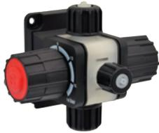
Mehrfunktionsventile für: Druck, Sicherheit, Anti-Siphon, Entgasung. Einstellbereich des Sicherheitsventils: 1 bis 18 bar. Einstellbereich des Druckventils: 1 bis 5 bar. Vorlauf- und Verbindungsanschlüsse können an Rohre unterschiedlichen Durchmessers angepasst werden. Körper aus PVDF und O-Ring aus FKM B oder EPDM.
