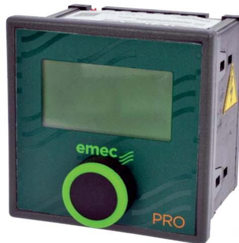
Die JA PRO-Kontrollgeräte bilden eine Serie von einzelnen Unterputz-Kontrollsystemen (96x96) mit Temperaturanzeige. Ein/Aus, impuls-proportional und PID sind die Hauptarbeitsmodi. Die JA PRO-Kontrollgeräte ermöglichen die Regelung und Steuerung von: Gesamtchlor, freiem Chlor, Chlordioxid, Wasserstoffperoxid, Ozon, Brom, Peressigsäure (je nach verwendeter Sonde) und Leitfähigkeit (gemessen in  $\mu\text{S/S}$  - Ohm - TDS / PPM). Die Sonden sind im Lieferumfang nicht enthalten.
